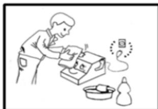
8- به منظور صحت عملکرد و ایمنی دستگاه، اتصال ارت دستگاه به سیم چاه ارت مناسب و یا فوندانسیون باسکول الزامی است.
